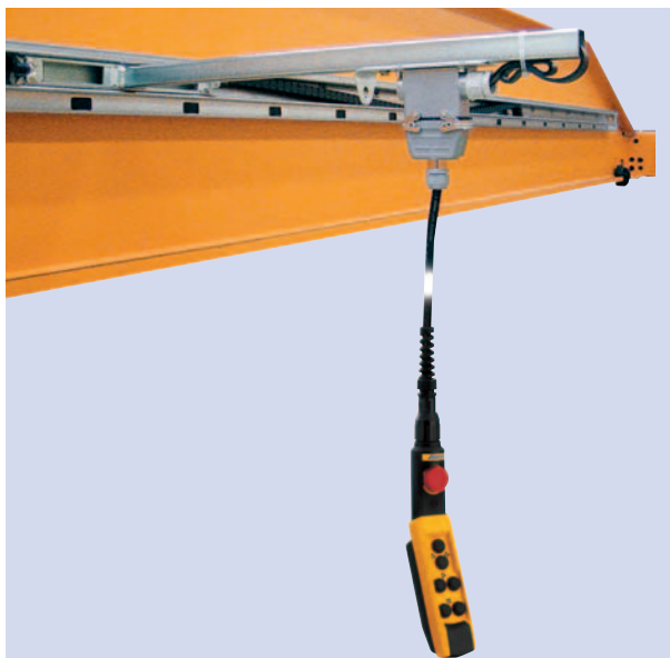
Signalübertragung zum Hängetaster
